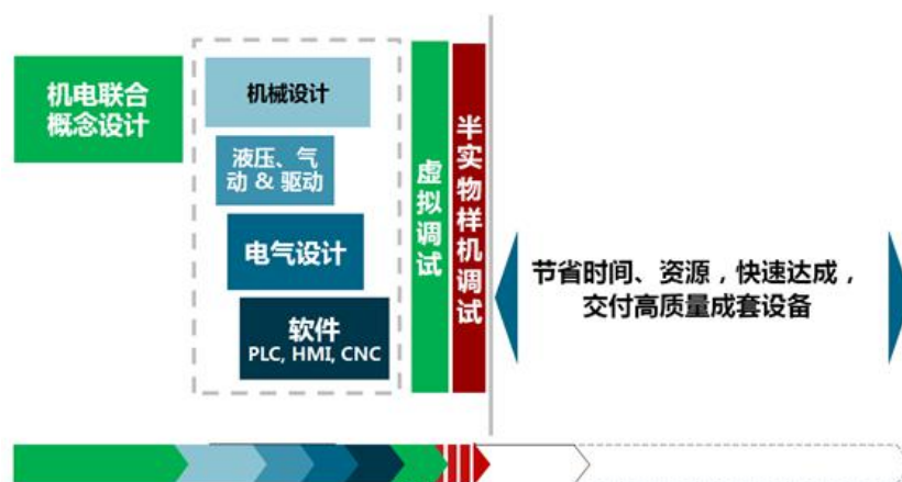
图 17 在 NX MCD 平台上机电联合设计及虚拟调试的流程
